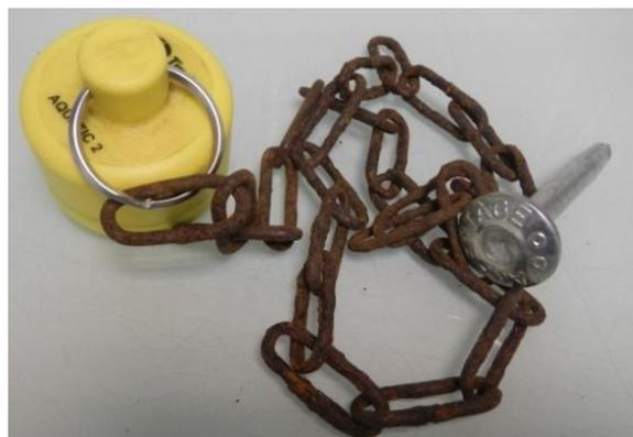
**FIGURE 3 : SONDE THERMIQUE ENREGISTREUSE TINYTAG AQUATIC 2.**
